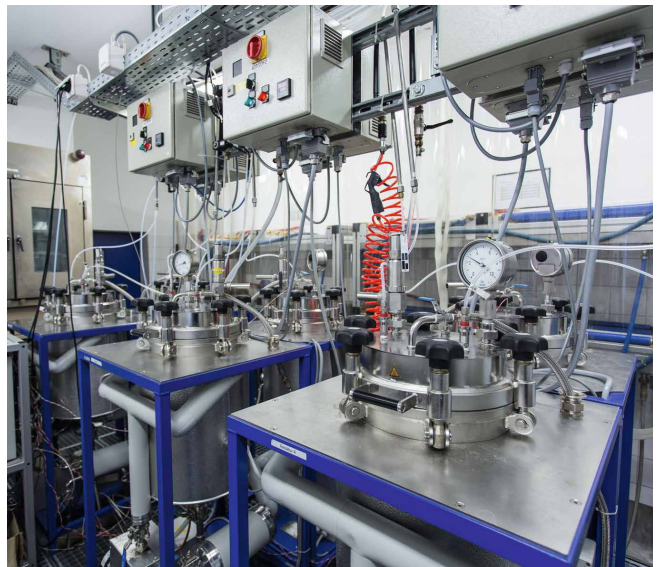
In diesen Autoklaven werden Werkstoffproben unter hohem Druck und mit deutlichem Sauerstoffüberschuss so lange «gekocht», bis sie spröde werden.
