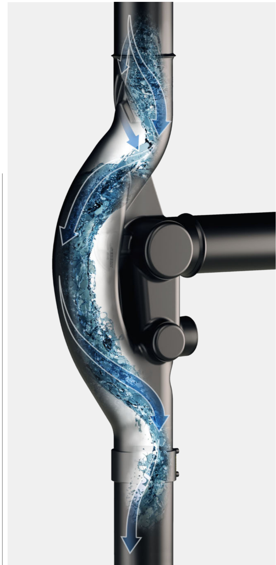
↑ Diese grafische Darstellung des Sovent Formstücks basiert auf den Daten der Computersimulation.
