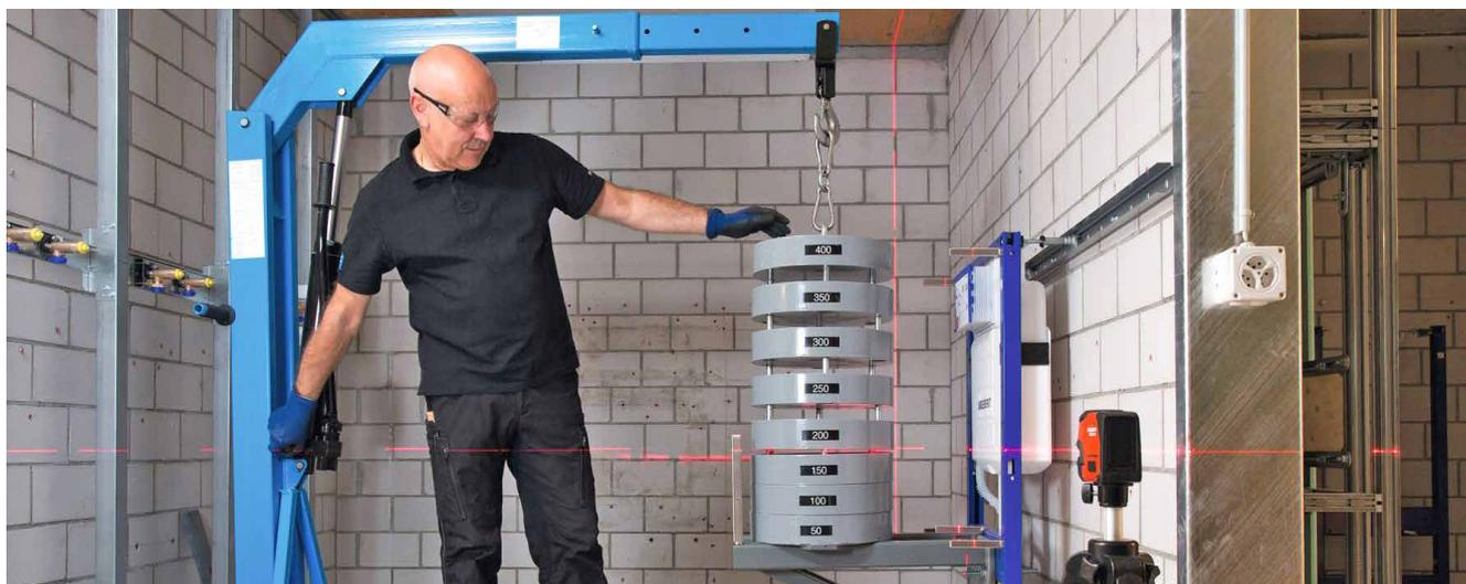
René Gmür, Statikspezialist bei Geberit, senkt acht Stahlscheiben mit einem Gesamtgewicht von 400 Kilogramm auf einen Tragrahmen, der an den gleichen Punkten wie ein WC an einem Duofix Installationselement befestigt ist. Dank Laserlicht können die Verformungen des Elements genau ermittelt werden.
