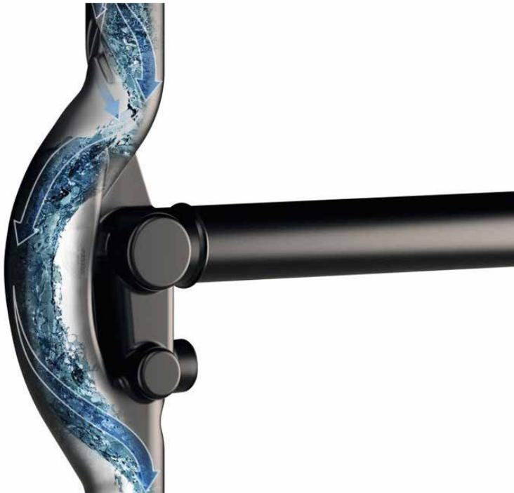
Dank leistungsfähigen Simulationsprogrammen können strömungsmechanische Abläufe dargestellt werden. Hier wird deutlich sichtbar, wie das in einen Fallstrang eingebaute Sovent Formstück die Wassersäule in eine rotierende Bewegung versetzt.
