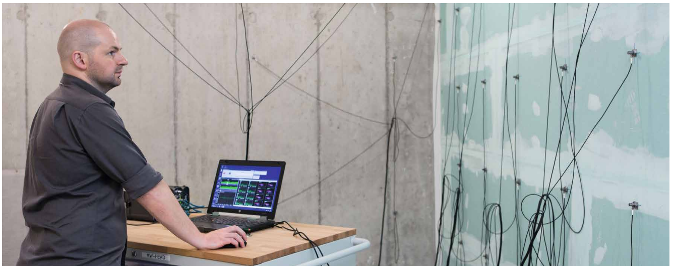
Samuel Pasteur, Akustikspezialist bei Geberit, misst mittels Beschleunigungssensoren die Schallübertragung von einer Unterputzinstallation auf einen benachbarten Raum.
